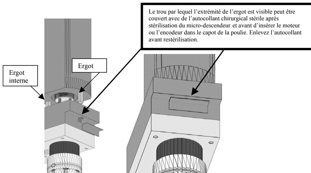
De plus, la conception de la partie supérieure recouvrant l'entraînement des poulies du micro-descendeur est en cours de changement pour englober les deux ergots afin d'éliminer ce risque d'exposition. Un représentant Medtronic vous contactera lorsque le nouveau capot de poulie sera disponible, afin d'effectuer un remplacement gratuit dans votre centre.
