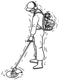
En cas de secousses ou de vibrations, arrêtez immédiatement la machine. Une vibration soudaine indique la possibilité d'un incident dangereux, par exemple une rupture du volant, de l'embrayage ou de l'outil de coupe ou des pièces desserrées. Ne reprenez pas le travail avant d'avoir identifié et résolu le problème.
