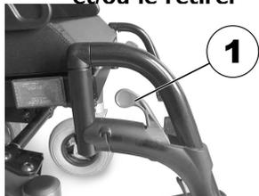
Le petit levier de déverrouillage se trouve dans la partie supérieure du repose-pieds (1). Lorsque le repose-pieds est déverrouillé, il est possible de le faire pivoter vers l'intérieur ou vers l'extérieur pour s'installer dans le fauteuil, ou même de l'enlever complètement.
