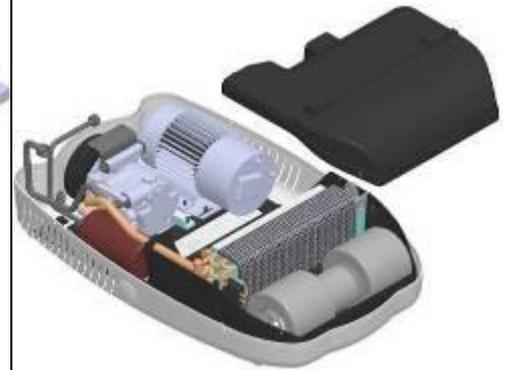
3. Enlever les 6 vis de fixation du capot du caisson évapo., et enlever le capot.
