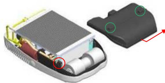
2. Enlever les 6 vis de fixation du capot du caisson évaporateur. Soulever légèrement le condenseur, avancer le capot du caisson évaporateur pour dégager les supports du condenseur (entourés en vert), puis faire glisser le capot sur le côté
