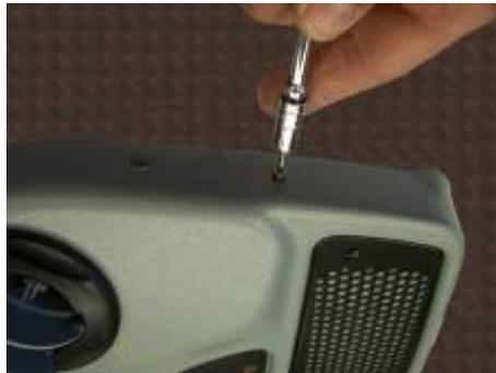
2. Rebrancher le connecteur du panneau de commande, remettre la console en place et revisser les 4 vis de fixation
