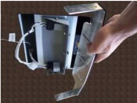
1. Revisser la plaque de fixation de la console en l'ajustant à l'épaisseur du plafond. S'assurer de l'étanchéité de part et d'autre de cette plaque
