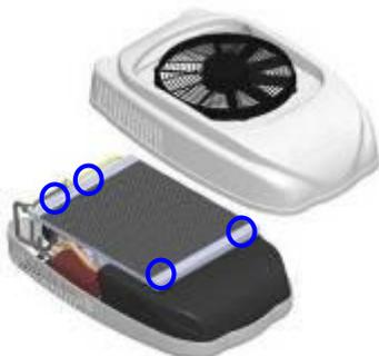
1. Enlever les 6 vis de fixation du capot extérieur, soulever le capot et débrancher le connecteur du ventilateur. Enlever les 4 vis de fixation du condenseur (entourées en bleu)
