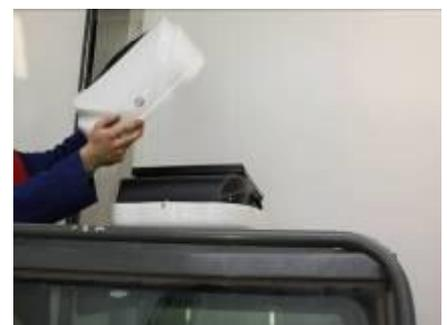
3. Enlever le capot de l'unité en dévissant les 6 vis et en débranchant le connecteur du ventilateur
