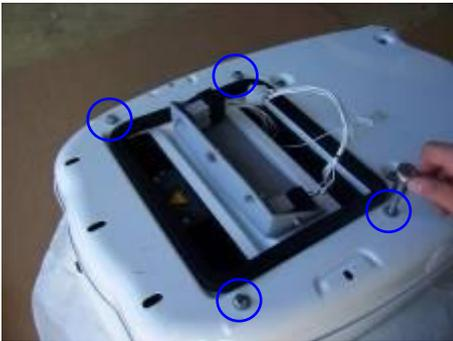
Dévisser les 4 vis de fixation de l'unité sur le toit entourées en bleu
