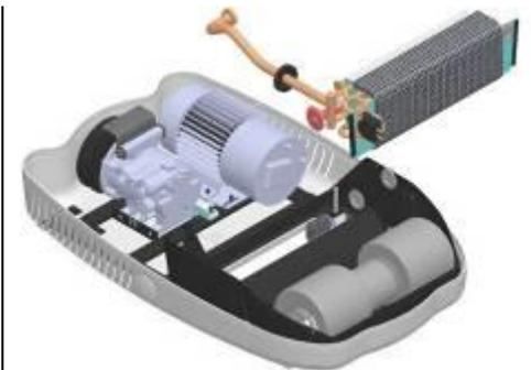
6. Soulever l'évaporateur et changer la mousse anti-projection d'eau, puis repositionner l'évaporateur.
