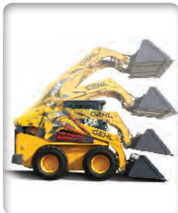
**LE BRAS DE LEVAGE VERTICAL** offre une portée plus étendue et une plus grande hauteur de levage, afin de faciliter le chargement du camion et la manipulation des matériaux à l'aide d'un mouvement quasi vertical.
