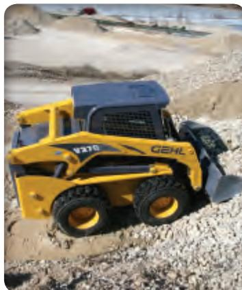
**L'EMPATTEMENT ÉLARGI** de plus de 1 265 mm permet d'améliorer la stabilité de l'engin pendant le levage et le chargement, tout en garantissant un plus grand confort en cas de déplacement sur terrain irrégulier.
