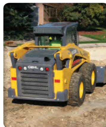
**LE CHÂSSIS ROBUSTE** du modèle V330 offre une excellente répartition du poids, améliorant ainsi la stabilité. Un amortisseur arrière offre une protection supplémentaire.
