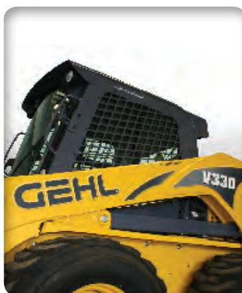
**UNE EXCELLENTE VISIBILITÉ** sur les côtés, l'arrière et l'avant de l'engin, grâce au bras de levage unique à profil surbaissé. Un toit vitré permet à l'opérateur de voir le bras de levage lorsqu'il est entièrement soulevé.
