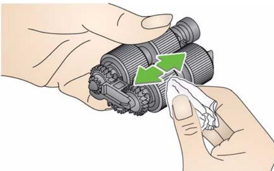
4. Examinez le module d'alimentation. Si les anneaux du module d'alimentation sont usés ou endommagés, remplacez-les ou changez de module d'alimentation. Consultez la section « Remplacement du module d'alimentation et de ses anneaux », plus loin dans ce chapitre.
