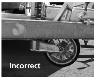
Roue jockey qui n'a pas été remontée correctement avec la manivelle
