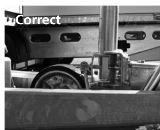
Roue jockey qui a été remontée correctement avec la manivelle
