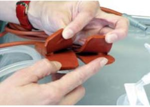
1. Placer le dispositif de chauffage sur le filtre stérile de la sortie d'air (le filtre de sortie d'air est équipé d'un tube prolongateur doté d'un raccord luer femelle).
