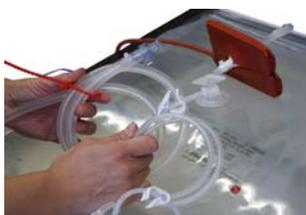
1. Connectez le tubage du récipient du milieu à la chambre du CultiBag RM en veillant à la stérilité. Pour cela, utilisez les raccords luer ou MPC pour connecter deux tubes.
