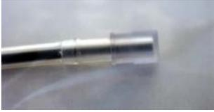
3. Les câbles à fibres optiques sont insérés jusqu'à ce qu'ils entrent en contact avec la surface intérieure des capuchons du capteur. S'il n'y a aucun contact entre le câble à fibres optiques et le capuchon du capteur, aucun signal ne sera plus mesuré. Serrer les vis des raccords pour verrouiller les câbles à fibres optiques.
