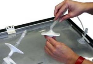
1. Connectez la BIOSTAT® RM Control Tower 200 avec le filtre stérile d'entrée d'air du sac CultiBag RM à l'aide du tubage livré (le filtre stérile d'entrée est le filtre à air). Si deux CultiBag RM sont utilisés en même temps, connectez le second sac de la même façon.
