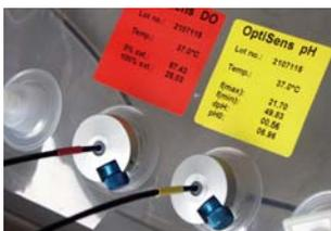
1. Il faut gonfler le CultiBag RM optique ou perfusion pro. Il n'est pas possible d'introduire les câbles à fibres optiques dans les ports d'un CultiBag RM optique on gonflé. Introduisez les raccords dans les deux ports de mesure des valeurs du pH et DO.
