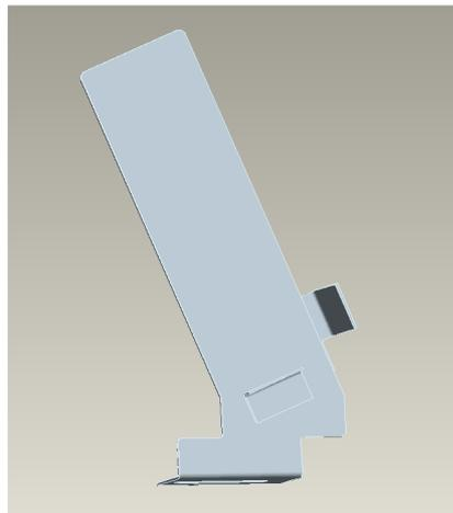
Ces plaques de côtés sont reliées aux supports couteaux par une tôle d'acier d'épaisseur 4mm. Grâce à ce système, le réglage des chargeurs et des couteaux se fait simultanément.
