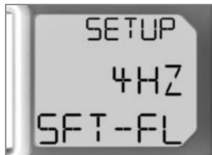
Fréquence de clignotement de la lampe éclair et de l'avertissement de dépassement de vitesse en Hz (1/s).
