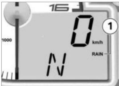
Après le branchement du connecteur de codage, le mode RAIN **1** est automatiquement activé pour des raisons de sécurité.
