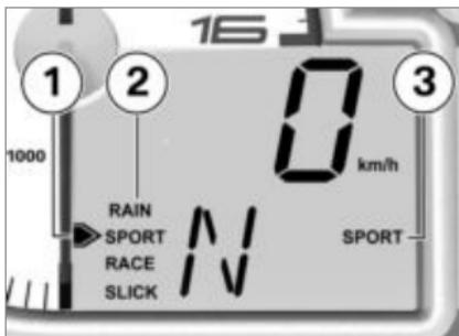
La flèche de sélection **1** et le menu de sélection **2** s'affichent avec les quatre modes possibles. Le réglage actuel est affiché au niveau de la position **3**.◀
