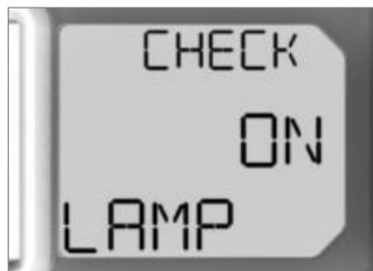
Si une lampe est retirée pour le mode circuit de compétition ou si le support de plaque est démonté, l'électronique de bord détecte cet état comme étant un défaut de lampe et affiche le message d'avertissement correspondant sur l'écran.
