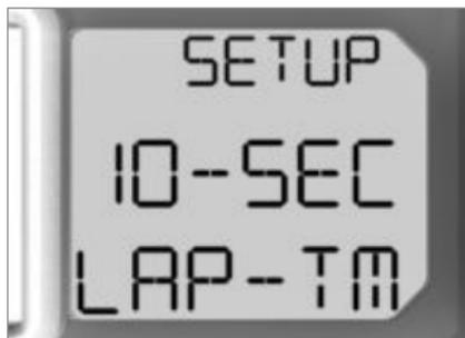
En cas d'utilisation d'un récepteur à infrarouges pour la détermination des temps par tours, il est possible de régler le temps qui doit s'écouler après un signal reçu avant qu'un nouveau signal n'est accepté. Ceci permet d'éviter d'exploiter les signaux de plusieurs émetteurs se trouvant l'un à côté de l'autre.
