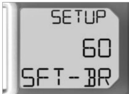
Affichage de la luminosité de la lampe éclair en pourcentage de la luminosité maximale. La lampe éclair est restée activée pendant le réglage et est immédiatement adaptée à la luminosité sélectionnée.
