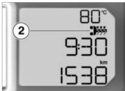
Le chauffage des poignées du guidon est à deux niveaux. Le deuxième niveau **2** sert pour le réchauffement rapide des poignées ; il est recommandé de revenir ensuite au premier niveau.
