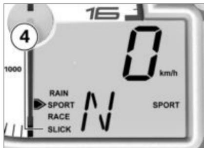
Lorsque le connecteur de codage est inséré, le mode de conduite **SLICK 4** est proposé
