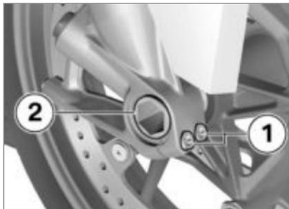
**!** La vis de blocage de l'axe de gauche fixe la douille filetée dans le guidage de la roue avant. Pour garantir le positionnement correct de la douille filetée, il ne faut pas détacher ni dépo-
