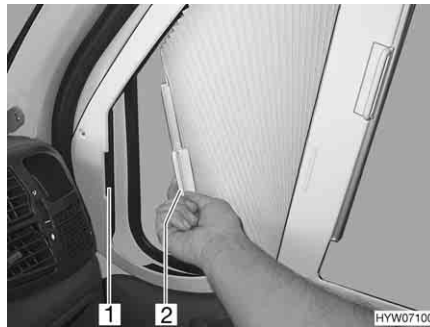
Fig. 11 Dispositif occultant plissé pour la fenêtre côté conducteur/passager
