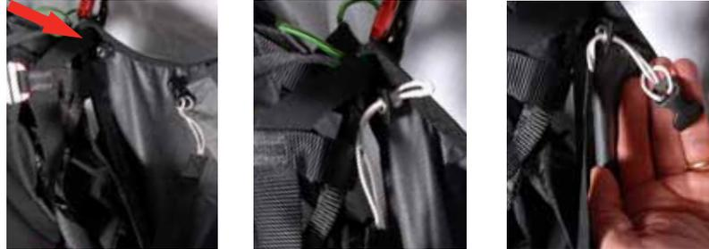
6 : Sangles tension Speedbag (E) à gauche : démonter la boucle plastique, passer le cordon dans l'oeillet sous le mousqueton et dans l'oeillet du Speedbag et refaire la «tête d'alouette» sur la boucle plastique.
