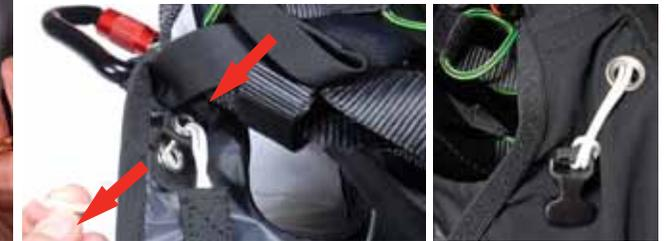
7 : Montage du Cockpit, enclencher les boucles plastiques côté droit du cockpit et de la sellette (sous le mousqueton).
