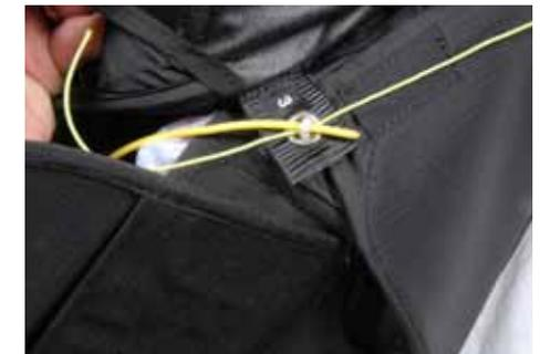
1. Rentrer le parachute de secours dans la poche de la sellette en ouvrant tous les volets. Le POD doit être orienté avec la poignée vers le haut et les suspentes et élévateurs en bas.
