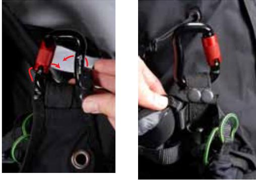
5 : Sangles tension Speedbag (E) à gauche démonter la boucle plastique, passer le cordon dans l'oeillet sous le mousqueton et refaire la «tête d'alouette» sur la boucle plastique.
