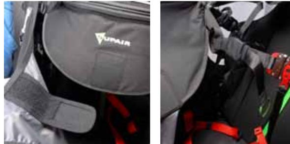
9 : Passer la sangle de fermeture du Speed bag dans le passant de sangle du Cockpit.
