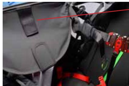
En vol : l'inclinaison du Cockpit peut être bloquée avec la sangle de maintien à faire passer derrière la ventrale.
