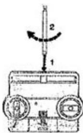
Posez et vissez l'antenne sur la télécommande dans le sens des aiguilles d'une montre et déployez l'antenne.
