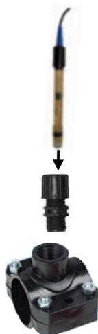
1/ Positionner le collier de prise en charge au milieu d'une canalisation horizontale en orientant l'orifice 1/2" vers le haut.
