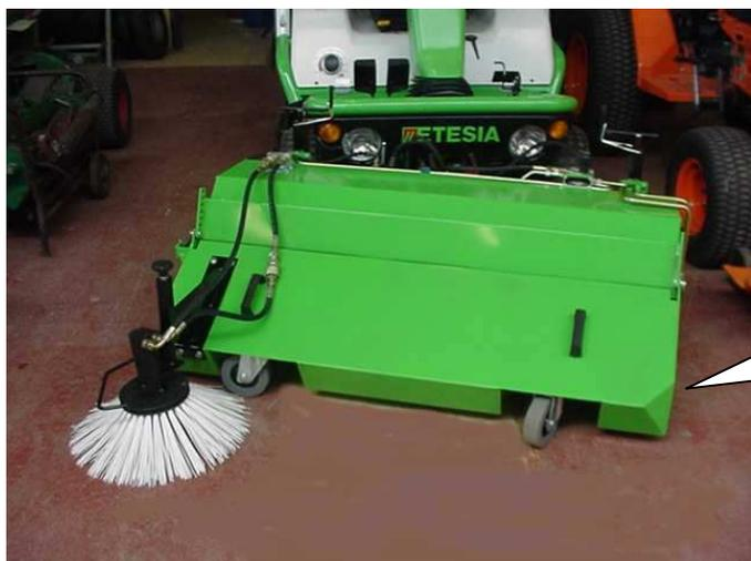
La balayeuse est ici en position de d'orientation vers la droite, la même manœuvre peut se faire vers la gauche avec moins d'utilité du fait qu'il n'y a pas "de balai de coin".
