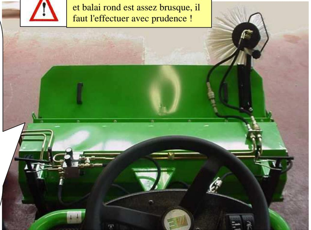
On a depuis le poste de conduite une excellente visibilité sur la machine et l'avancement. Les commandes électrohydraulique sont sur le tableau de bord
