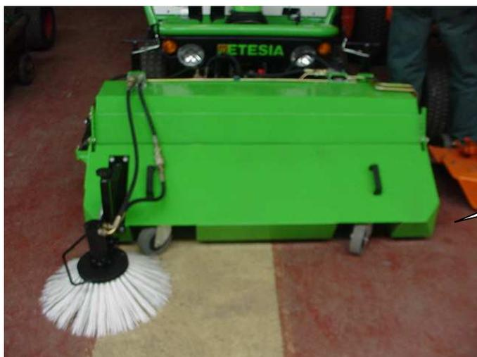
Vue avant de la balayeuse en position de travail. Le corps de la machine est perpendiculaire à la H 124 D et donc de l'axe d'avancement.
