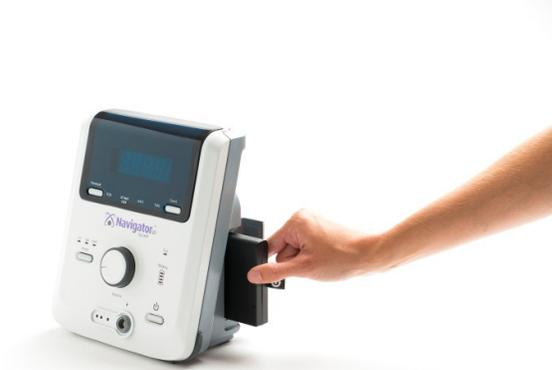
Fermez le volet du compartiment de la batterie. Le volet fait entendre un « dé clic » s'il est correctement fermé.
