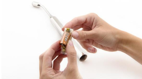
3. Introduisez le pôle négatif (-) du support de la pile dans la sonde en le faisant légèrement pivoter pour le mettre en place.
