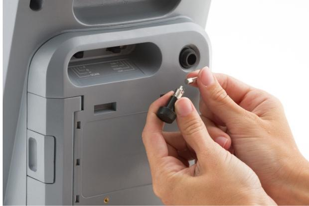
3. Insérez un fusible neuf dans le support.
