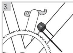
3. Avant d'ajuster le Capteur sur le tube diagonal, le tube vertical ou la tige de selle, vérifiez que son emplacement est propre et sec. Si le Capteur touche la manivelle (lorsque celle-ci tourne), positionnez celui-ci un peu plus haut. Dans un premier temps, serrez légèrement les colliers de serrage, afin que le Capteur ne bouge plus. Ne serrez pas encore fortement.
