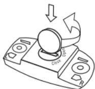
1. Ouvrez le boîtier de la pile de l'émetteur à l'aide d'une pièce de monnaie, en la tournant dans le sens inverse des aiguilles d'une montre, de la position CLOSE (fermé) à la position OPEN (ouvert).
