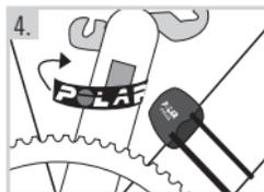
4. Positionnez l'aimant assez haut et du côté intérieur de la manivelle. Avant d'ajuster l'aimant sur la manivelle, vérifiez que son emplacement est propre et sec. Fixez l'aimant à la manivelle avec l'adhésif fourni.
