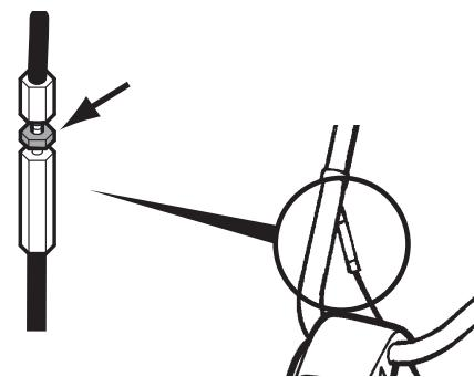
5: Détendre complètement le câble (la boule à l'extrémité du câble ne doit plus être en contact avec le ressort) (la boule à l'extrémité du câble doit être en appui sur le ressort)
