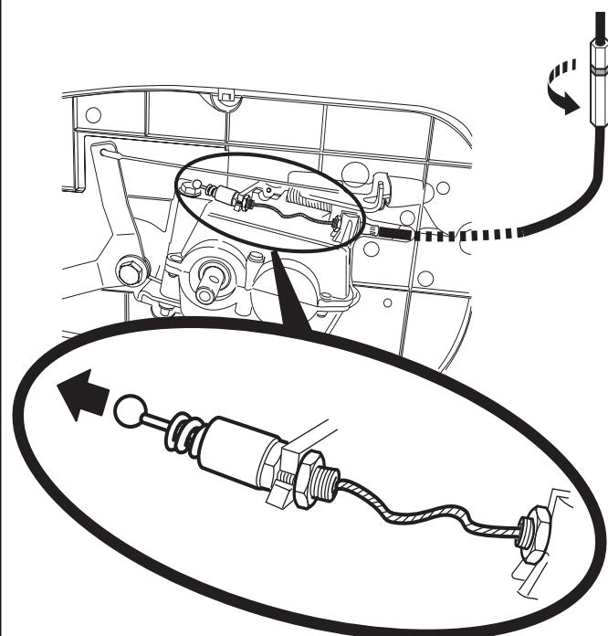
6: Retendre le câble sans comprimer le petit ressort (la boule à l'extrémité du câble doit être en appui sur le ressort)
