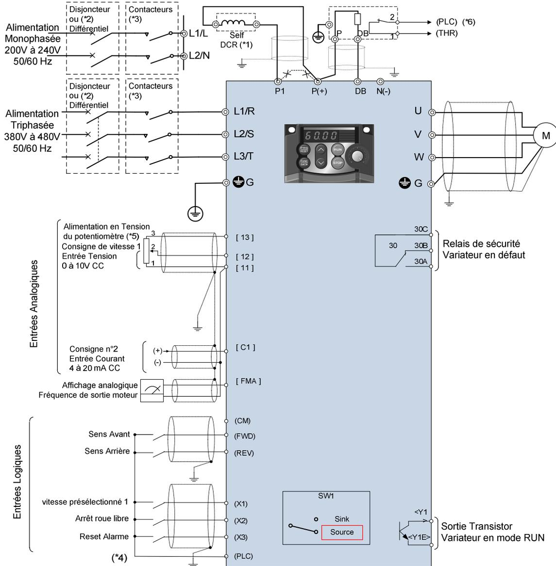
Ce schéma est donné à titre d'exemple. Pour des schémas de câblages détaillés, se reporter au manuel d'instruction correspondant.
