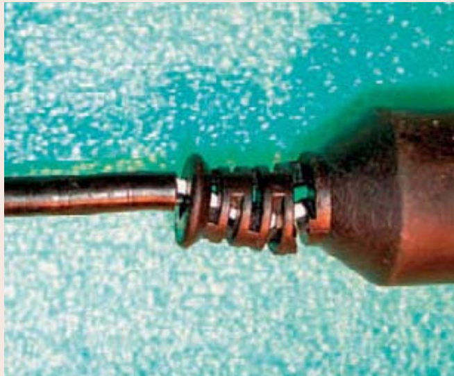
Si vous tirez sur le cordon d'alimentation au lieu de tirer sur le connecteur, vous abîmerez les fils électriques
