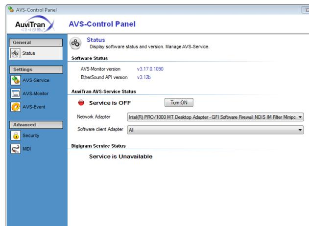
4. Dans l'onglet *Status*, sélectionner l'adaptateur réseau adéquat dans le menu déroulant *Network Adapter* (celui en lien avec le réseau des amplificateurs);
