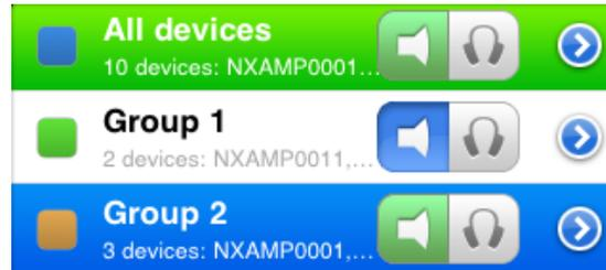
Sur cet exemple, comprenez que tous les amplificateurs du *Group 2* sont sélectionnés, aucun du *Group 1* ne l'est, et les amplificateurs du groupe *All devices* (tous les modules) sont partiellement sélectionnés (au moins deux ne le sont pas, ceux du *groupe 1*, et au moins 3 le sont, ceux du *groupe 2*).
