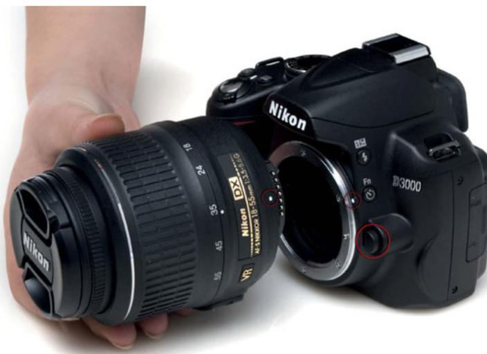
**4** Pour monter l'objectif, maintenez les repères alignés ; pour le démonter, il suffit de presser le bouton à gauche de l'objectif tout en tournant l'optique dans le sens des aiguilles d'une montre
