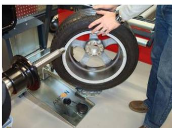
Tourner la roue sur la plaque rotative pour roues.
