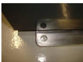
Fixer la machine et la télécommande au sol avec des boulons d'expansion.
