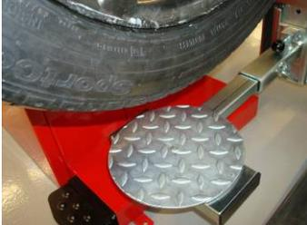
Lorsque la roue est correctement fixée, abaisser la plaque rotative pour roues de sorte que la roue puisse tourner librement.
