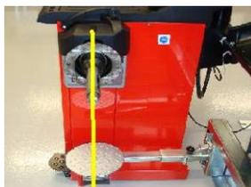
Placer la machine sur un sol plat et stable de sorte que le milieu de la plaque rotative/ de levage se trouve juste en face du dispositif de serrage de la machine à équilibrer.
