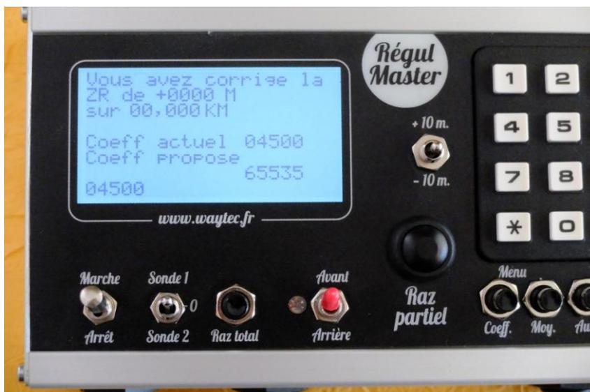
Si au cours d'une ZR, s'il y a eu des corrections avec l'inter + 10 m / - 10 m, l'appareil propose un nouveau coef d'étalonnage. Pour cela, en appuyant sur le bouton « suivant » aller sur l'écran « correction étalonnage ». Sur cet écran est indiqué le coef
