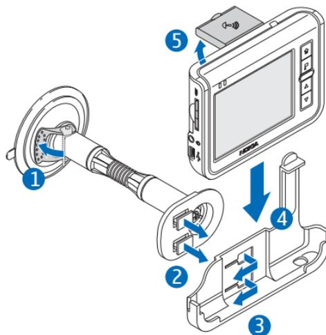
Pressez fermement la ventouse contre le pare-brise et poussez délicatement le levier de blocage situé au-dessus en direction de la ventouse pour créer un vide entre la ventouse et le pare-brise (1). Vérifiez que la ventouse est parfaitement fixée. Pour détacher l'appareil de fixation du pare-brise, poussez délicatement le levier de blocage vers le haut de l'appareil de fixation et tirez sur la languette située sur le bord de la ventouse.
