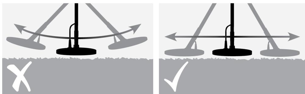
Figure 42 – Balayage de la tête de détection
