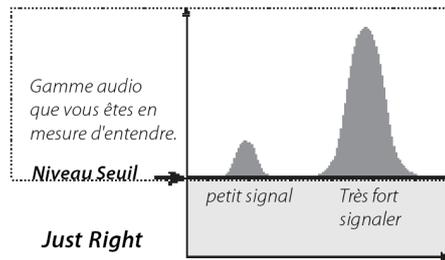
Réglez le Niveau Seuil à un ronronnement dissimulé et audible. Cela surlignera les variations de réponse de signal qui peuvent indiquer la présence d'une cible. Si les conditions du sol changent, le Niveau Seuil peut avoir besoin d'être réglé.
