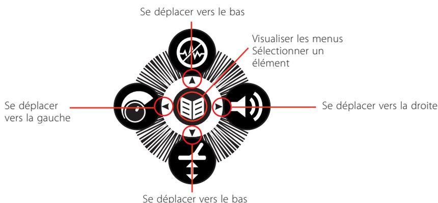
Figure 23 – Boutons de contrôle du CTX 3030
