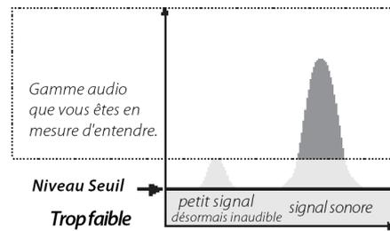
Si le Niveau Seuil est trop bas, la légère variation causée par une cible petite ou profonde peut ne pas être suffisamment audible. Régler le niveau pour réduire un niveau audible garantira un fonctionnement silencieux mais pourrait masquer la réponse audio des petites ou profondes cibles.
