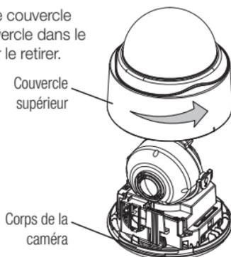
2. Maintenez le levier de verrouillage enfoncé vers le bas, dans la position orientée vers l'extérieur, tel qu'illustré, et tournez le corps de la caméra en direction de <UNLOCK>, dans le sens inverse des aiguilles d'une montre, pour retirer le support du corps.
