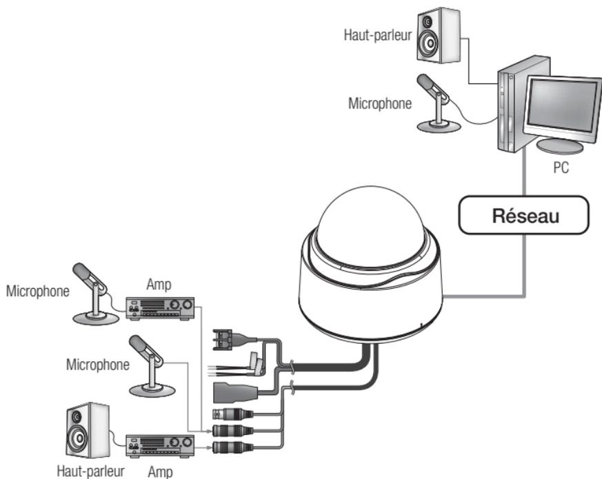
1. Connecter le port AUDIO IN de la caméra avec le microphone directement ou le port SORTIE DE LIGNE de l'amplificateur auquel le microphone est connecté.
