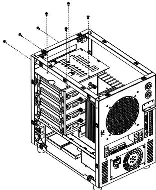
**3.** Installer votre radiateur de refroidissement à eau et verrouillez-le avec des vis.
