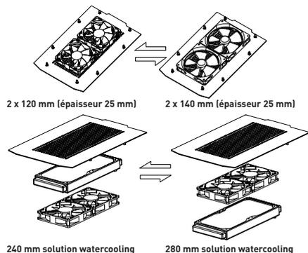
Note : Le ventilateur doit être placé en haut, le cache pour ventilateur doit être retiré
