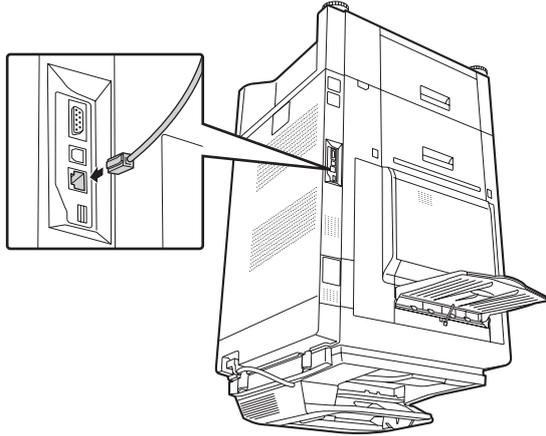
Après avoir connecté la machine à un réseau, veillez à configurer l'adresse IP et les autres réglages réseau avant d'installer le logiciel (l'adresse IP est configurée en usine pour recevoir automatiquement une adresse IP lorsque la machine est utilisée dans un environnement DHCP). Les réglages réseau peuvent être configurés dans "Réglages réseau" dans les réglages système (administrateur) de la machine.
