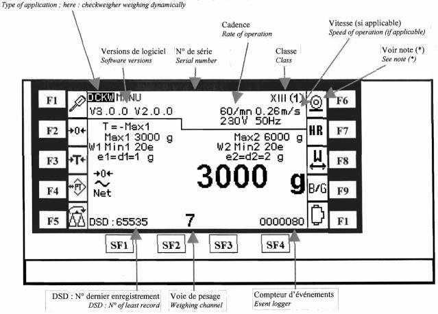
(\*) Note: Commande pour un pesage manuel permettant un enregistrement après interruption accidentelle du processus automatique
