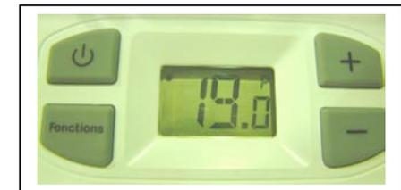
Par un appui bref sur la touche **Fonctions**, positionner l'afficheur de l'écran à cristaux liquides sur **19.0<sup>P</sup>**.
