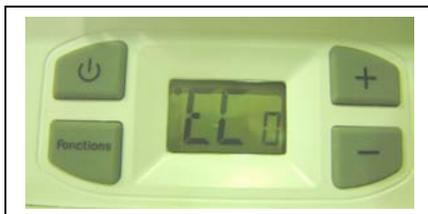
Appuyez sur les touches **+** ou **-** pour augmenter ou diminuer de 0,5 en  $0,5^{\circ}\text{C}$  la température désirée en mode Eco.
