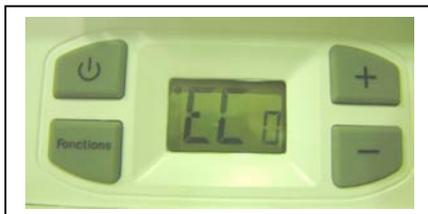
Pour visualiser la température Eco. Appuyez sur la touche **+** ou **-** et l'afficheur vous indiquera par défaut  $15,5^{\circ}\text{C}$  en température Eco.
