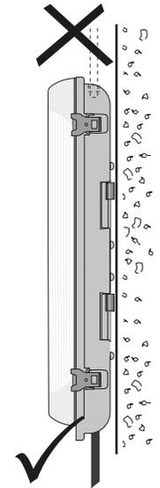
de Bei Wandmontage muss die Leitungseinführung unten positioniert sein.
