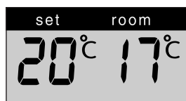
G: A gauche la température désirée, à droite la température mesurée.
