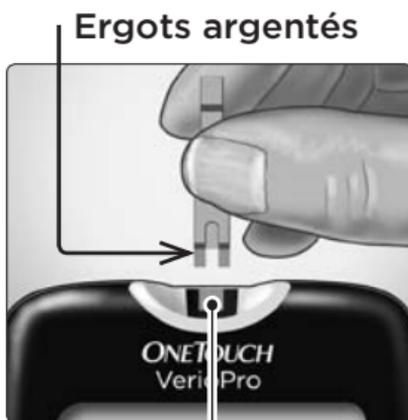
Fente d'insertion des bandelettes réactives
