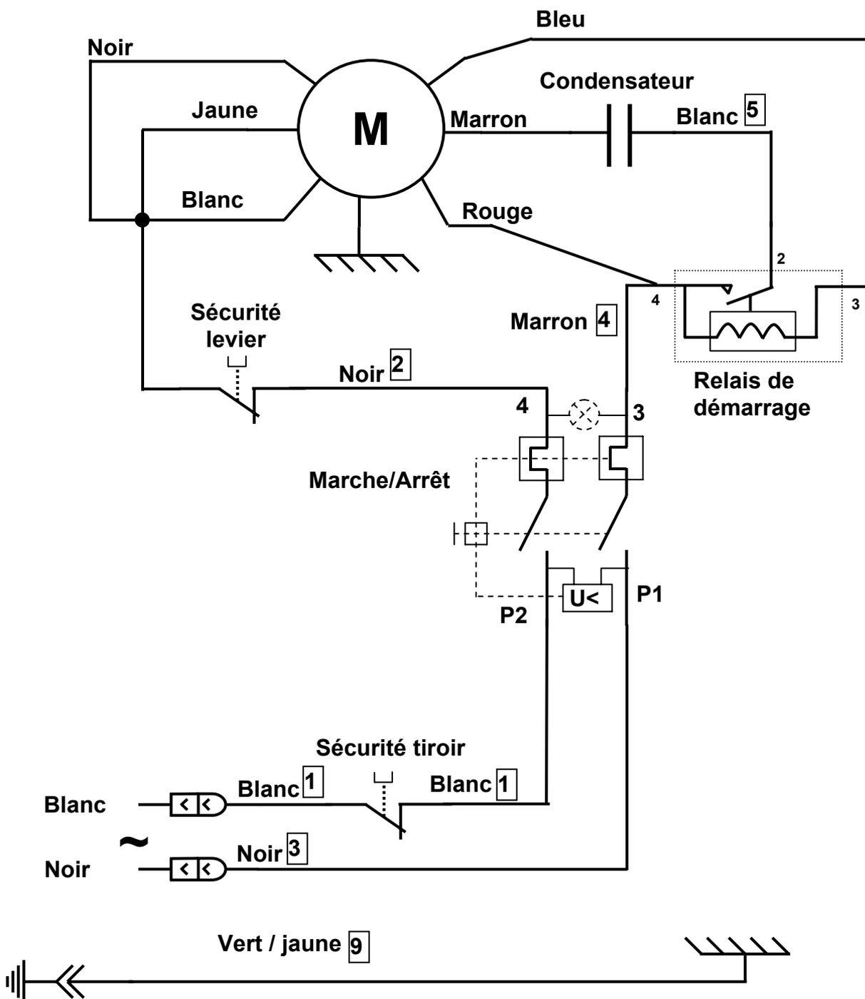
Schéma électrique 220-240V 60Hz
