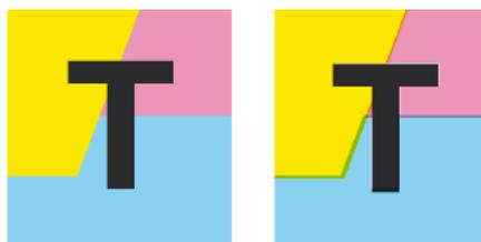
L'exemple ci-dessus représente une petite zone du travail en mode de prévisualisation normale (à gauche) et avec des erreurs de repérage (à droite). Dans ce cas, vous pouvez clairement voir qu'aucun recouvrement n'a été appliqué. Les lignes blanches apparaissent donc au niveau des décalages de repérage.
