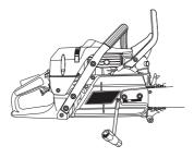
La chaîne est tendue correctement quand elle ne pend plus sous le guide et peut être avancée à la main sans difficulté. Serrer les écrous du guide à l'aide de la clé universelle tout en maintenant levé le pignon du guide.
