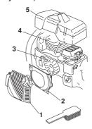
Nettoyer le système de refroidissement avec une brosse une fois par semaine, voire plus souvent dans des conditions difficiles. Un système de refroidissement sale ou colmaté provoque la surchauffe de la machine, endommageant le cylindre et le piston.
