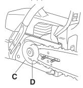
L'arceau protecteur ne déclenche pas seulement le frein de chaîne. Il réduit aussi le risque que la main gauche ne se blesse à la chaîne en cas de perte de la prise sur la poignée avant.
