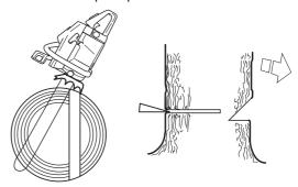
Le trait de chute doit s'achever parallèlement à l'encoche, l'espace entre les deux étant 1/10 du diamètre du tronc. La partie non coupée du tronc s'appelle la charnière.
