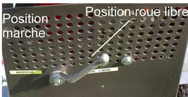
Figure 1 Vanne de mise en roue libre
