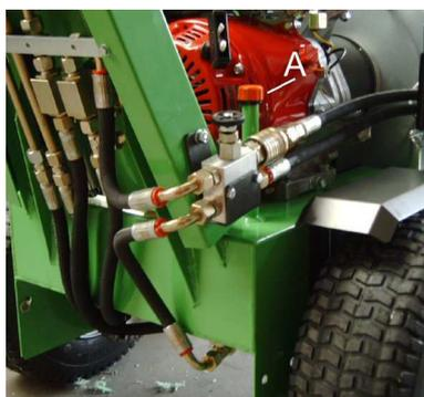
Photo 2 Prise d'air circuit hydraulique
