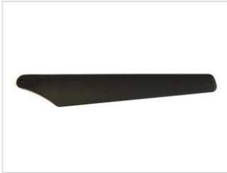
1 Rotor bas pour l'hélico SYMA S032G. Attention: pour son bon fonctionnement, 2 rotors hauts et 2 rotors bas sont nécessaires!
