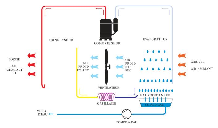
Le déshumidicateur utilise le circuit de réfrigération pour transformer l'air humide en air sec et chaud Lorsque l'air humide passe dans l'évaporateur, l'eau de l'air se condense et l'air devient sec.
