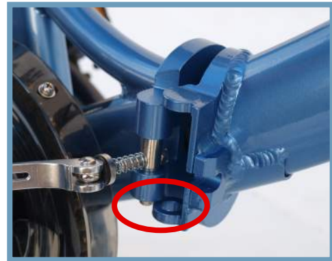
Clip de sécurité à dégager du trou du cadre lors du pliage.
