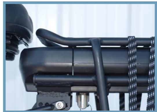
Batterie bien enclenchée.
