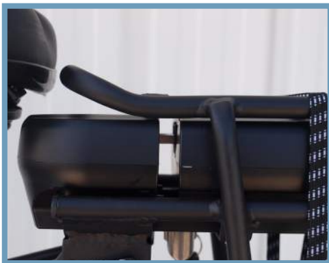
Batterie mal enclenchée.
