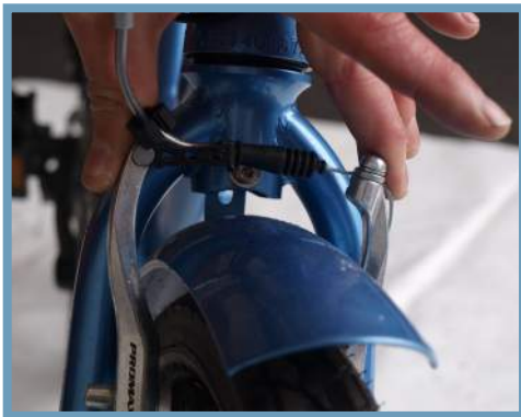
Desserrez le serre câble du frein V-Brake.
