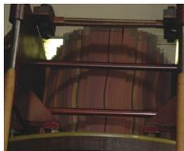
Circuit magnétique déformé
