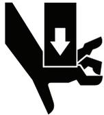
Peligro de machucado. El pistón de engarce funciona a alta velocidad y con mucha potencia y puede ocasionar lesiones graves. Mantenga todas las partes del cuerpo alejadas de las piezas móviles de la herramienta, en especial del riel en T del cabezal y del porta matriz durante la operación.
