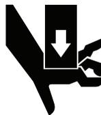
Danger lié aux pinces. Un vérin à sertir fonctionne à grande vitesse et exerce une grande force et peut causer des blessures graves. Gardez toute partie du corps loin des pièces en mouvement de l'appareil, particulièrement de la zone T de passage de la tête et du support de la matrice lors du fonctionnement de l'appareil.
