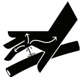
Líquido hidráulico a presión. NO use ninguna parte de su cuerpo para detectar fugas hidráulicas. El líquido que escapa a presión puede causar lesiones graves o la muerte. Si se escapa el líquido a presión y se causa heridas, busque inmediatamente atención médica para evitarse lesiones graves.
