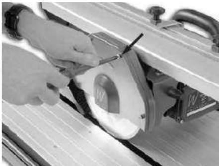
Le protecteur extérieur est fixé à l'aide de quatre vis cruciformes ; à l'aide d'un tournevis cruciforme, ôtez les vis et enlevez le protecteur pour avoir accès au disque, placez la vis en sécurité à portée de main. (Voir fig. N)
