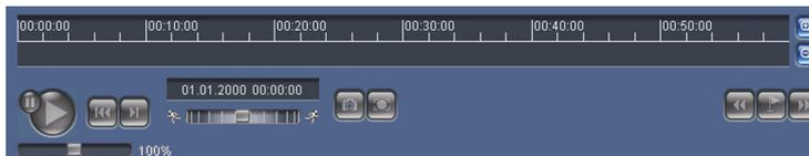
La barre de temps située sous l'image vidéo vous permet de vous repérer aisément. L'intervalle de temps associé à la séquence est affiché en gris dans la barre de temps. Une flèche verte au-dessus de la barre indique la position de l'image affichée dans la séquence.
