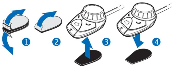
Fixez ensuite la bande à crochets : retirez la feuille de protection de la partie adhésive (2) et fixez la bande sous l'unité de commande (3).
