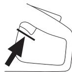
Appuyer sur le blocage d'accélérateur et vérifier qu'il revient en position initiale quand il est relâché.
