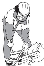
Saisir ensuite la poignée de démarrage de la main droite et tirer lentement sur le lanceur jusqu'à ce qu'une résistance se fasse sentir (les cliquets d'entraînement grippent), puis tirer énergiquement et rapidement sur le lanceur.
