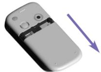
3. Déverrouillez le verrou rouge de la batterie pour libérer la batterie. Puis, avec votre doigt, levez la batterie du côté gauche du connecteur.
