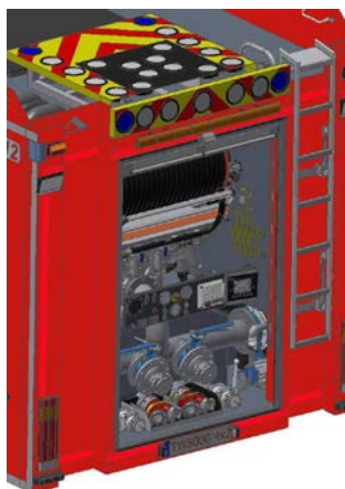
Vu arrière compartiment pompe
